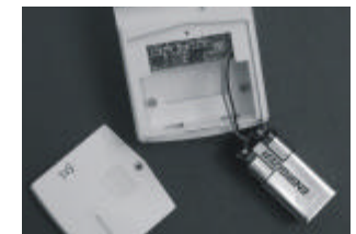
Insérez une batterie alcaline 9V dans le détecteur de mouvements
